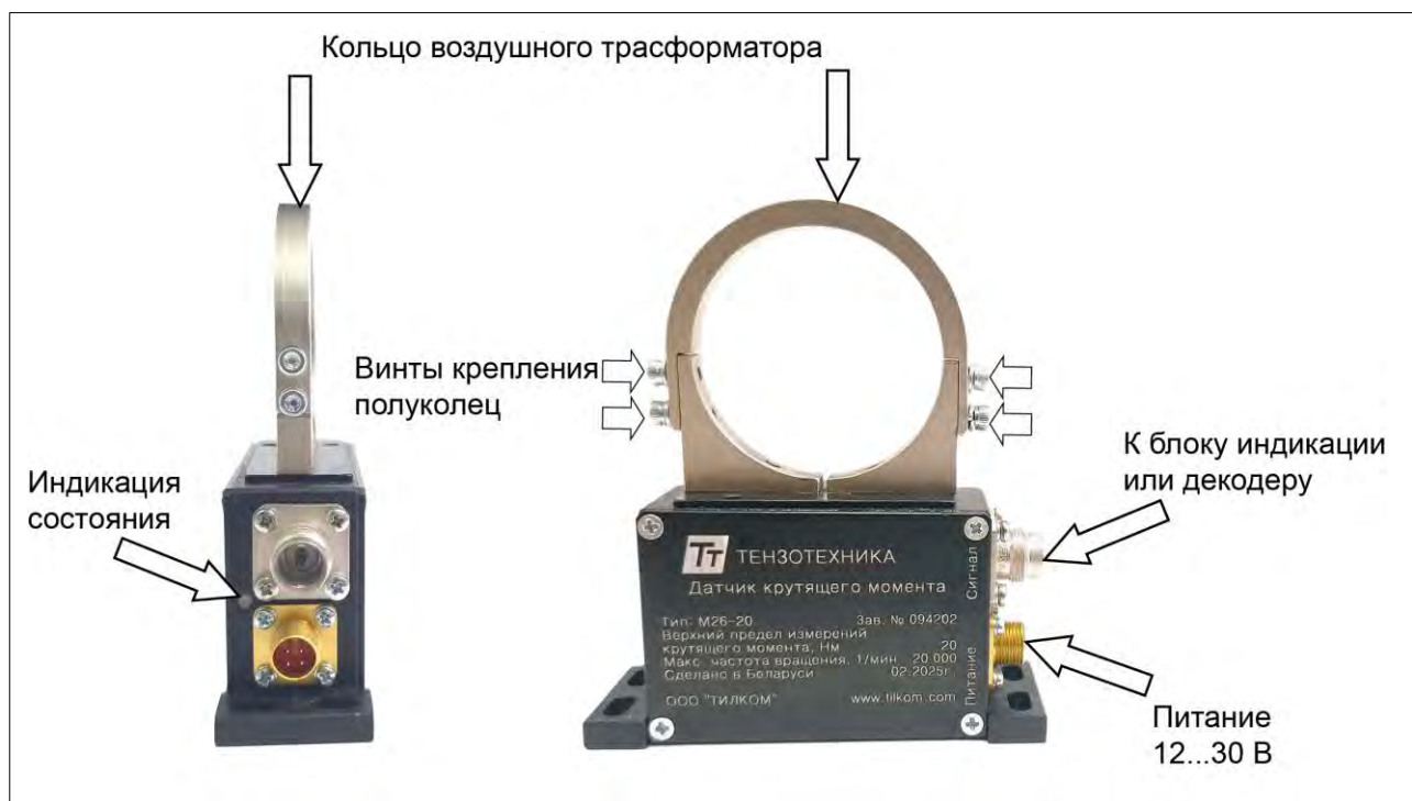
Рис. 3 – Статор датчика M26
